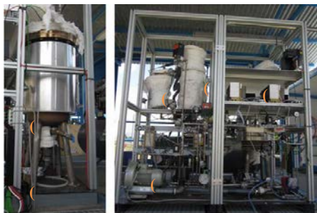
Fig. 5. Vista de: (1) reactor de reformado y (2) quemador integrado; (3) reactor WGS y (4) COPROX, (5) soplante alimentación quemador, (6) 2 x PEMFC.
