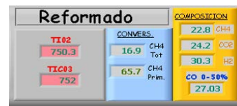
Fig. 7. Fragmento de la pantalla del sistema de control donde se recoge la información del reactor de reformado.
