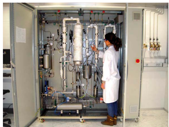
Fig. 2. Sistemas de producción de hidrógeno mediante tecnología de reformado, en el laboratorio de Abengoa Hidrógeno en el Campus Palmas Altas (CPA).
