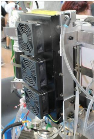
Fig. 3. Pila de combustible PEM integrada en el robot
