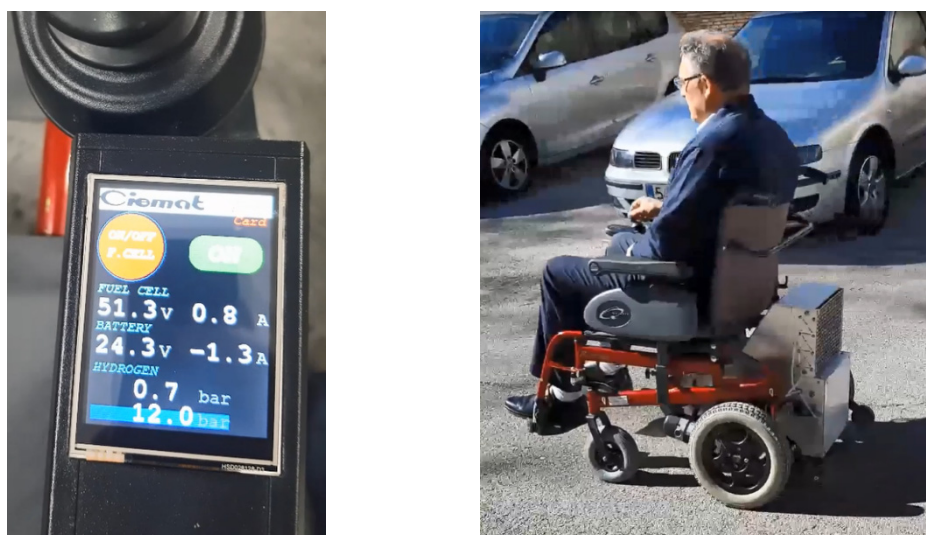
Fig. 3. Izquierda, pantalla de control de la pila de combustible y variables de operación del sistema. Derecha, la silla en funcionamiento con el propulsor de pila de combustible instalado
