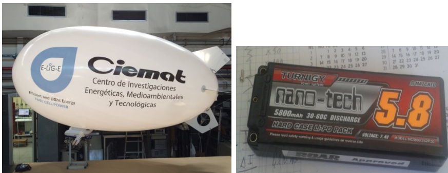
Fig. 3. Fotografías del globo dirigible (Izqda.), y de la batería utilizada para propulsión del modelo comercial (dcha.).
