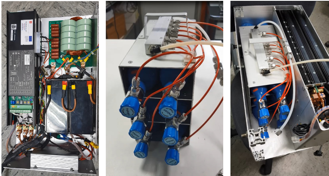
Fig. 2. Esquema inicial y modificación introducida. A la izquierda, zona eléctrica con convertidor DC/DC, filtro, baterías y caja de control de la PEMFC. En el centro grupo de botellas de hidruros para almacenamiento de 1,2 Nm3 de hidrógeno. A la derecha, acoplamiento final en él se aprecia la separación física de los dos compartimentos anteriores.
