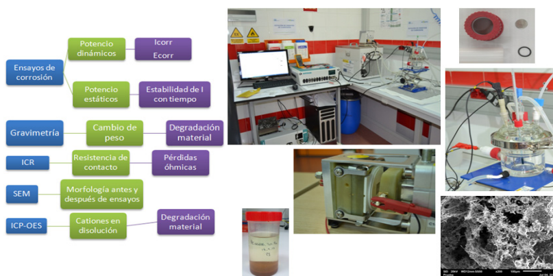
Fig. 3. Protocolo de ensayos seguido para la determinación de los mejores materiales para placa bipolar en PEMWE.
