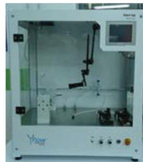
Fig. 1. Sistema de Electro-hilado (Electrospinning) en el Laboratorio de Tecnología de óxido sólido.
